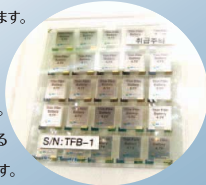
GSカルテックス社開発の Thin Film Battery (全固体薄膜電池) (写真提供:GSカルテックス社) 上は折り曲げた状態 下はシート状に繋がれたもの
